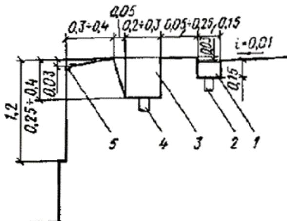
**Рис. 23. Схема борта ванны с раздельным отводом воды: из ванны - на очистку с обходных дорожек - в канализацию**
