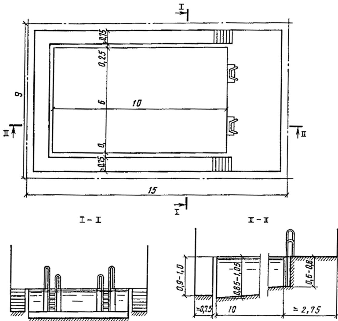
**Рис. 12. Схема зала с ванной для обучения не умеющих плавать детей с обходной дорожкой, пониженнной по 3 сторонам (размеры в м)**
