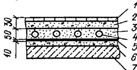
**Рис. 10. Схема конструкции обходной дорожки крытых бассейнов**
