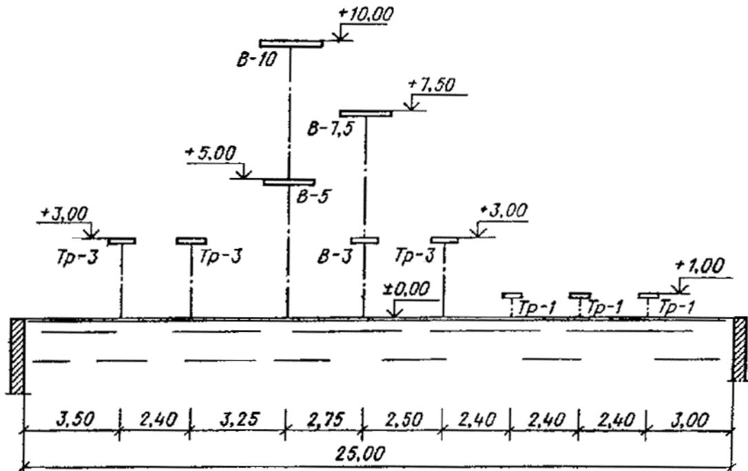
**Рис. 5. Схема расстановки прыжковых устройств в специализированной ванне вдоль стенки длиною 25 м**
