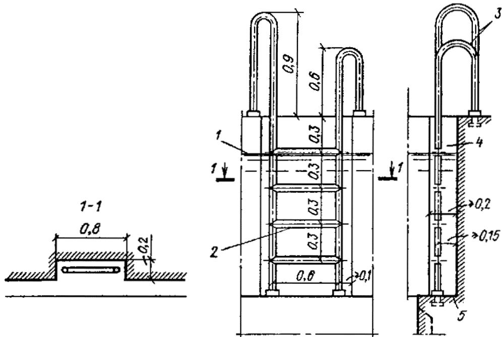
**Рис. 9. Схемы лестницы для выхода из ванны**
